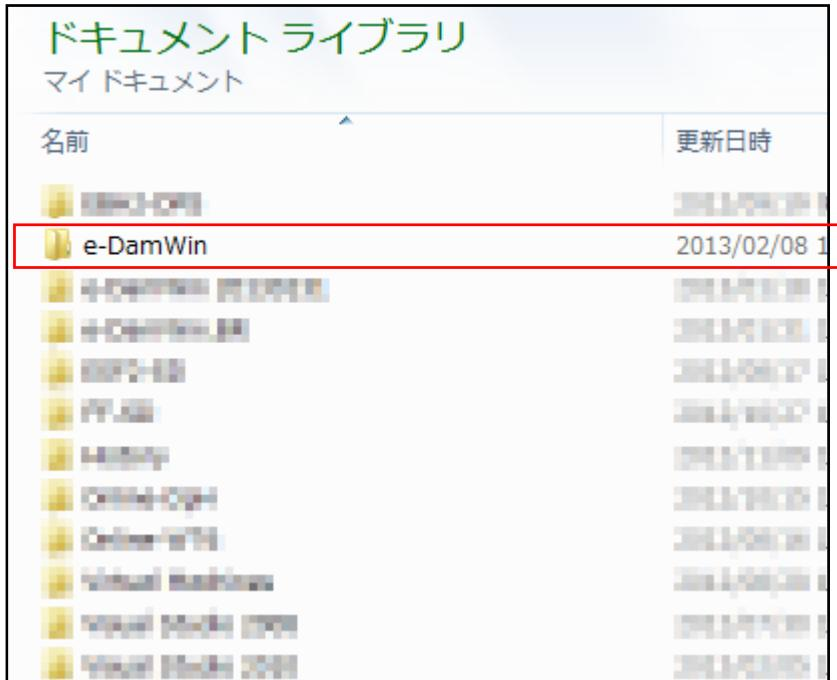
「e-DamWin」フォルダ以下には、登録した現場名のフォルダが作成され、現場単位で設置場所のデータを階層的に管理しています。
